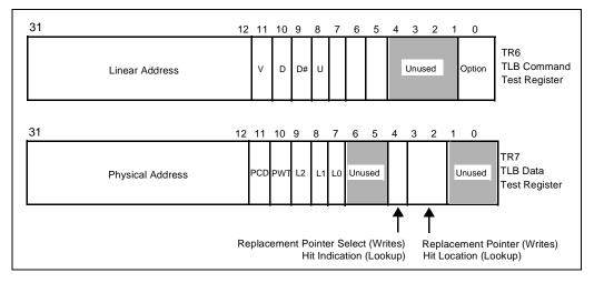
Figure B-6. TLB Test Registers
